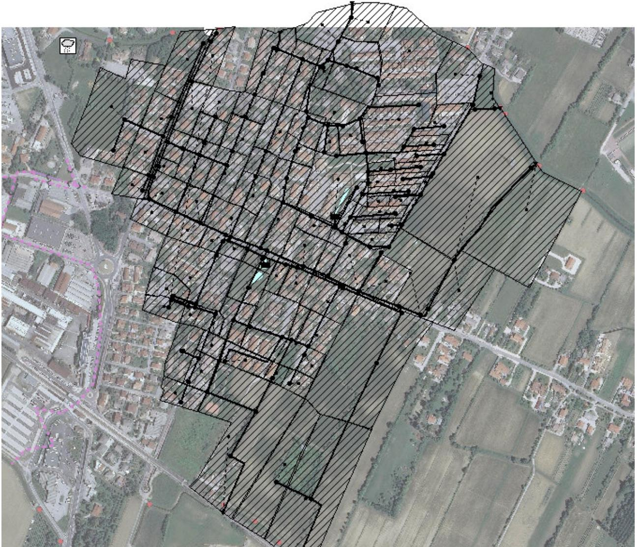
Figura 6 – Bacinizzazione e rete modellata allo Stato di Fatto col software SWMM-EPA.
