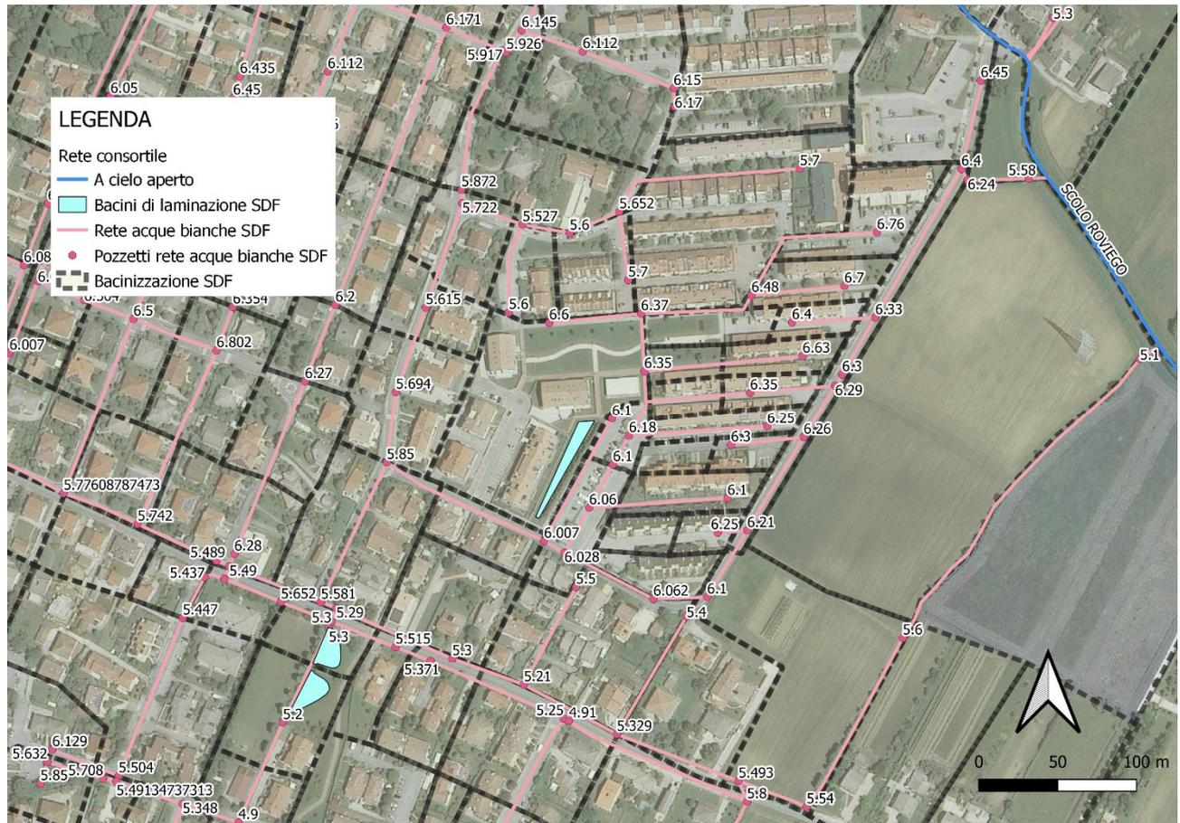
Figura 7 - Particolare della rete modellata di via Berti allo stato di fatto, con indicate le quote di scorrimento della rete ai nodi.
