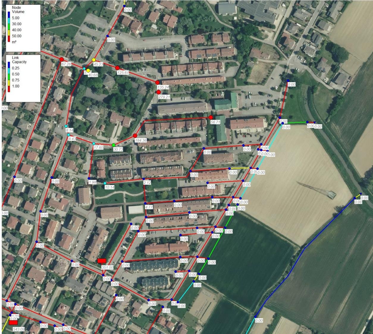
Figura 12 - Punti di esondazione da modello relativamente allo Stato di Progetto simulando lo scarico libero sullo scolo Roviego, con evento pluviometrico Tr 50 e tp 1 ora. Le etichette indicano il valore del volume massimo esondato al nodo.
