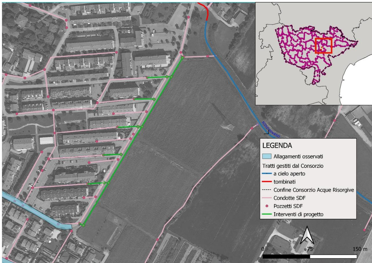
Figura 1 - Indicazione schematica della rete di condotte presente allo stato di fatto nell'area di progetto (in rosa) e degli interventi di progetto (in verde) su base ortofoto.
